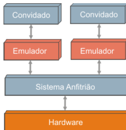
Figura 1.06 - Representação da execução de sistemas virtuais por emulação
