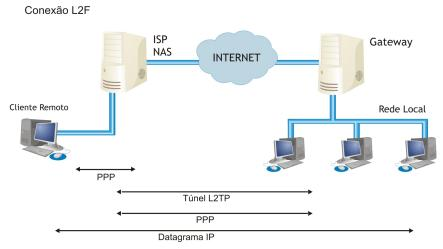
Figura 3 - Conexão L2F
