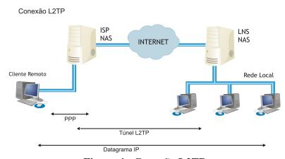
Figura 4 - Conexão L2TP
